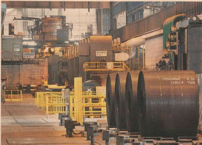
Tecnologia di frontiera. Il nuovo processo produttivo sviluppato da Arvedi a Cremona consente di creare nastri di spessore ultrasottile laminati a caldo (anche di 0,8 millimetri) ed è coperto da oltre 400 brevetti globali
